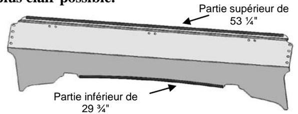
b) Assemblez les charnières (Article D) aux pare-brise supérieur et inférieur (article A & B) tel que montré. **Optionnel : Appliquer la bande protectrice au pare-brise supérieur entre les charnières, ceci éliminera tout bruit indésirable pouvant être causé par la vibration.**
